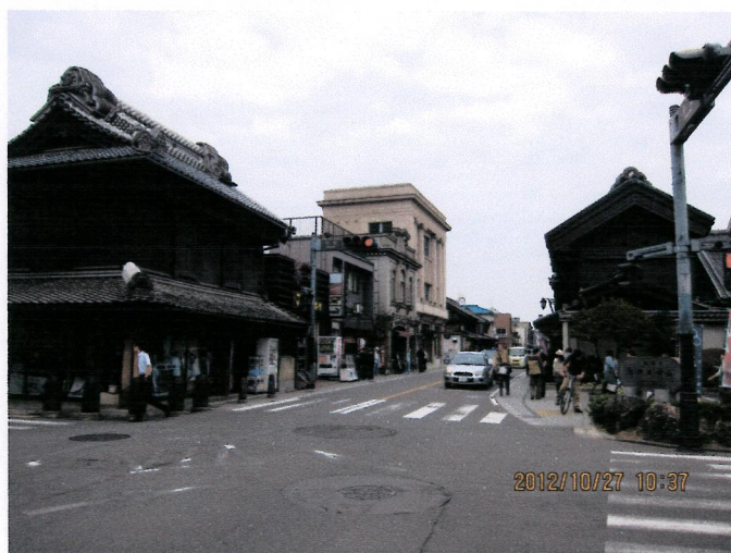
信号機以外に電柱など無し
